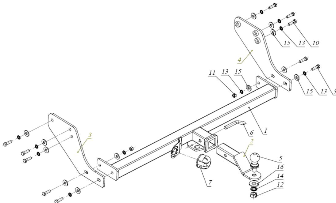
1. Выкрутить болты крепления задней подножки к раме а/м. Установить кронштейн 3 и закрепить его болтами М12х1,25х50 (рис.1).
